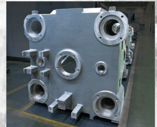
Name : End Plate Material : Casting
