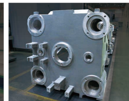
Name : End Plate Material : Casting
